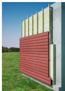
Mise en place d'un pare-pluie
