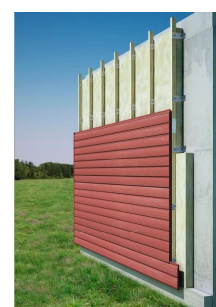
Mise en place d'un pare-pluie
