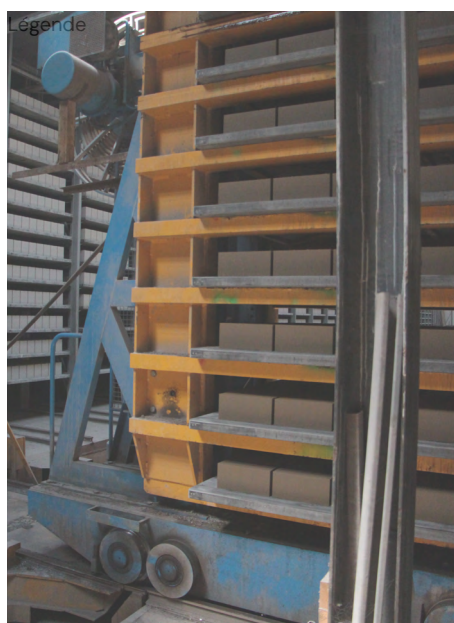
Déplacement des blocs vers le séchage
