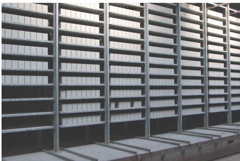
Espace de séchage des blocs
