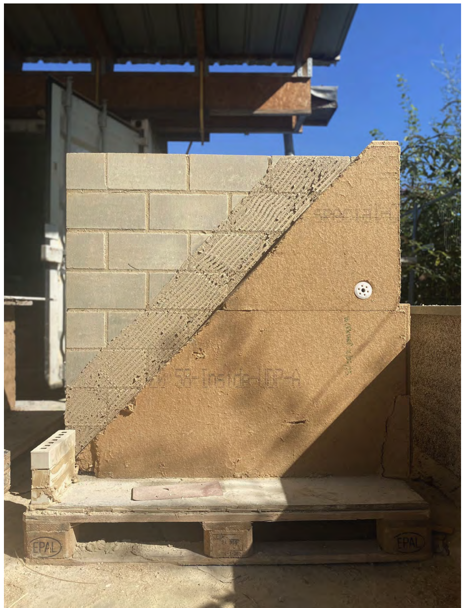
Prototype suivant la conception hygrothermique pour un mur extérieur
