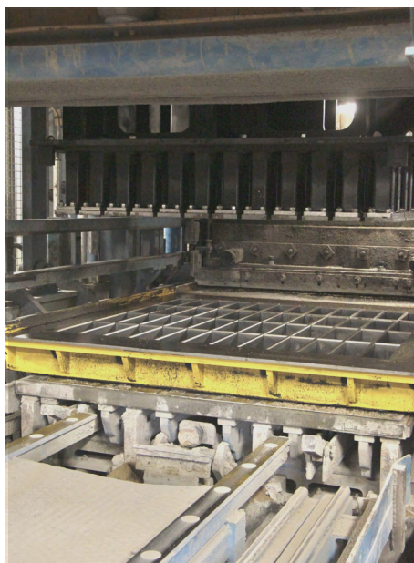
Mise en place des moules des blocs
