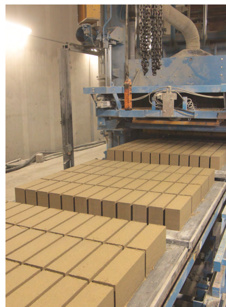
Blocs après vibrocompactage
