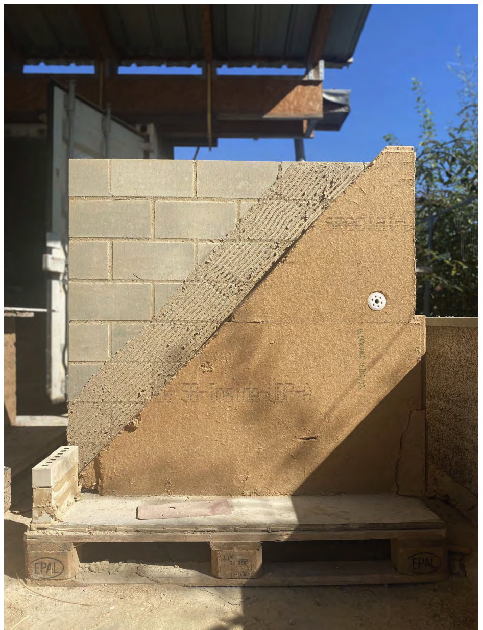
Prototype van hygrothermisch ontwerp voor een geïsoleerde buitenmuur
