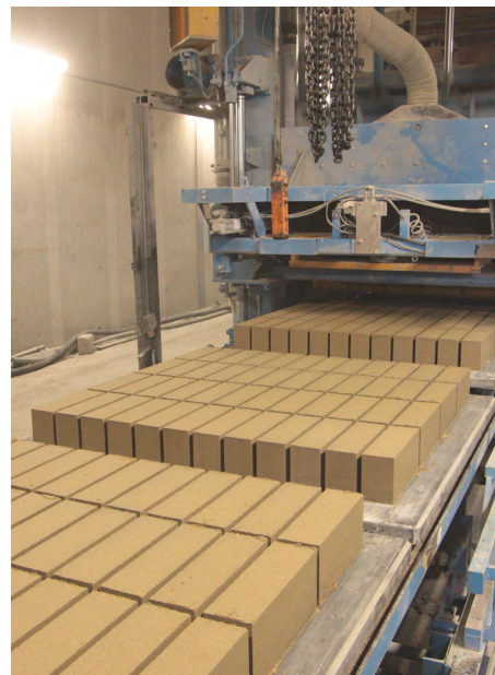
Léém Perssteen na vibrocompactie
