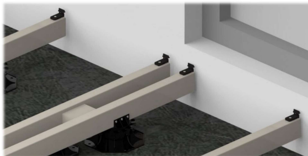
Afbeelding 15: Plaats de plank op de onderconstructie en druk de lipjes in de houders.
