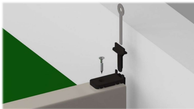
Afbeelding 13: RASK Start/End clip met alle onderdelen.
