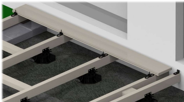
Figuur 16: Eerste plank. Schroef de terrasclips niet vast voor de volgende plank correct geplaatst is.
