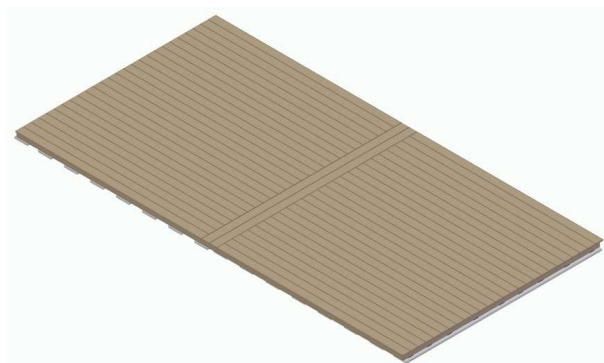
Afbeelding 8: Voorbeeld van een terras verdeeld in zones. Dergelijke oplossingen maken bijzonder goed gebruik van materiaal en creëren een exclusieve uitstraling. Pas de grootte van de zones aan aan de lengte van de terrasplanken.
