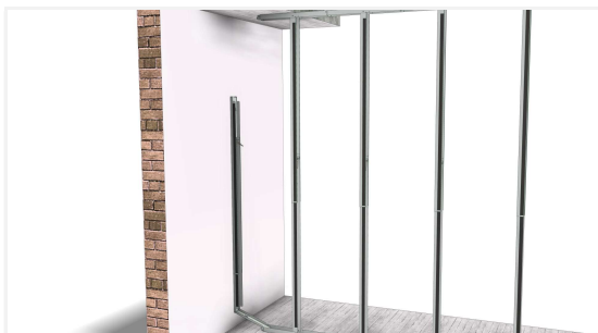
Klap de horizontale profielen uit.
