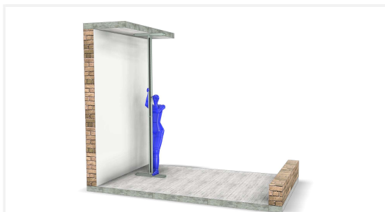
Span de module tussen vloer en plafond door de Quickspan te sluiten. Fixeer de module volgens hoofdstuk 3.4.
