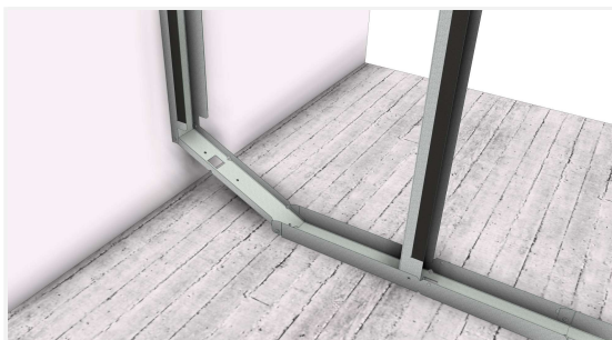
Plaats de C-module in de I-module.
