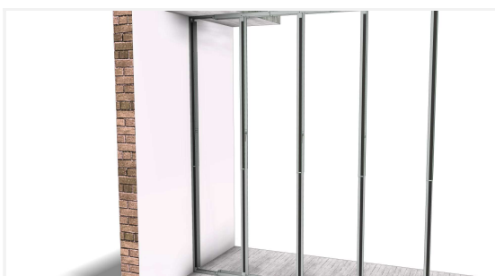
Klik de C-module bovenaan in de I-module en fixeer het geheel.
