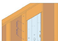
Etape 3 - Liaison avec les montants adjacents.
