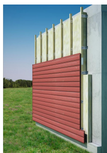
Mise en place d'un pare-pluie
