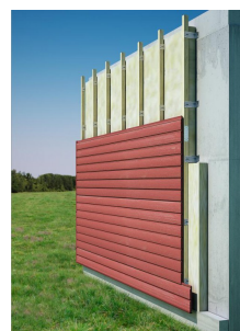
Mise en place d'un pare-pluie
