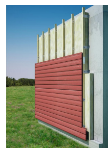
Plaatsing van een regenkap
