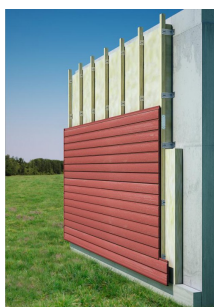
Plaatsing van een regenkap
