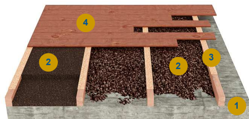
1 Dalle 2 Granulés de liège expansé ou aggloméré de liège expansé 3 Lames d'aggloméré de liège expansé (3 a 5mm) 4 Plancher en bois
