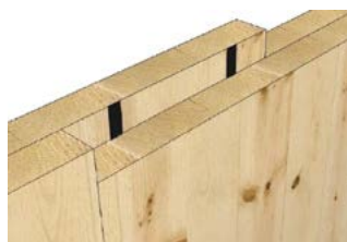
DETAIL OF A LONGITUDINAL JUNCTION 124, 84 – WITH OVERLAP / Detal wzdłużnego łączenia 124, 84 – z przeplataniem
