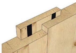
DETAIL OF A LONGITUDINAL JUNCTION 62 – WITH FASTENER / Detal wzdłużnego łączenia 62 – z nakładką
