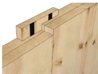
DETAIL OF A LONGITUDINAL JUNCTION 124, 84 – WITH FASTENER / Detal wzdłużnego łączenia 124, 84 – z nakładką
