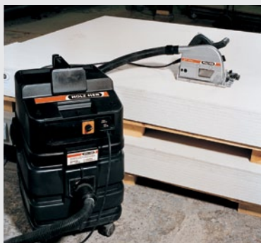
Afbeelding 3.3: Handcirkelzaag met stofafzuiging
