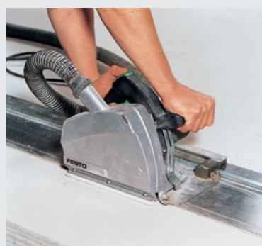
Afbeelding 3.2: Handcirkelzaag met geleidingsrail
