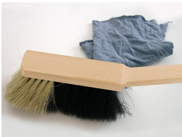
1. Vorbereiden Veeg de SOLITEX WELDANO 3000 schoon met bijv. een doek. Verlijmen op bevroren folies is niet mogelijk. Er mogen geen afstotende stoffen op de folies aanwezig zijn (bijv. vetten of siliconen). Ondergronden moeten voldoende droog en stevig zijn.
