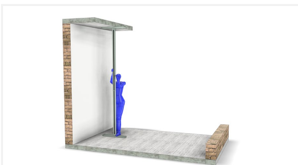
Fixez le module entre le sol et le plafond en fermant le Quickspan.
