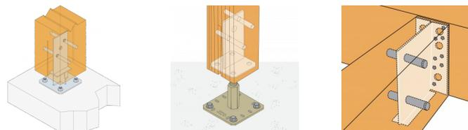
Les broches inox STDS sont essentielles à la reprise de charge des connecteurs structurels inox en âme Simpson Strong-Tie. Elles sont complémentaires des étriers à âme intérieure inox CBHS et permettent également d'assurer la fixation de poteaux bois sur les pieds de poteaux inox à âme intérieure PPS170IX et PPST230IX.
