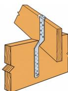
Les feuillards torsadés MTS assurent une résistance à la traction entre 2 éléments. Plus adaptés aux charpentes et aux contrevenements, ces feuillards offrent de nombreuses fonctionnalités. Le coude permet le pliage à 90° dans le sens de la longueur permettant ainsi l'assemblage d'éléments croisés à 90°.
