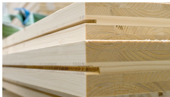
Les rainures du côté peuvent être effectuées par par la tronçonneuse.
