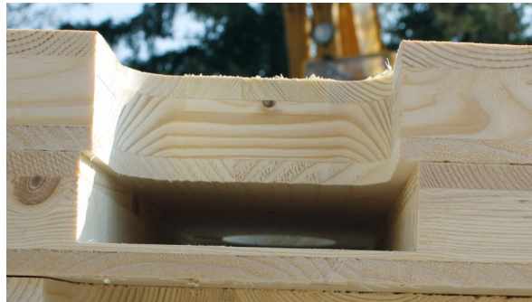
2. Fraise – défonçage de la reservation avant le contre-collage des panneaux.
