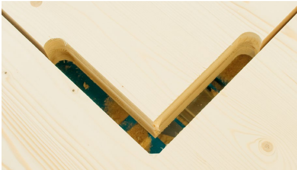
2b. Finition de la découpe par la fraise- avec rayon (qualité visible).
