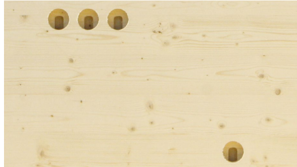
Il est possible de fraiser verticalement de haut en bas n'importe quel nombre de trous de différentes formes.
