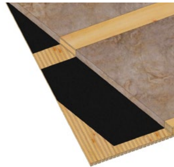
MARILYNE – détail avec Fibertex 75 g / m 2 , + Steico Flex. ép. 50 mm contre face du panneau
