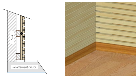
Détail de la finition par un tasseau
