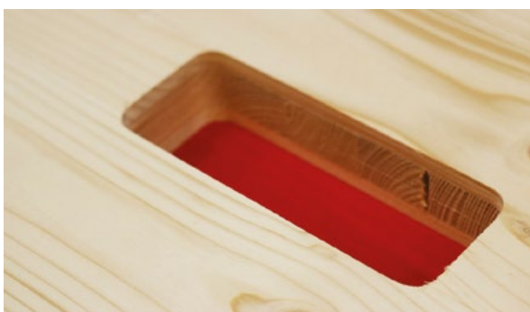
Usinage des ouvertures des formes différentes
