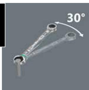
Au lieu des 60°, Joker offre un angle de reprise de 30° couplé à un mécanisme dodécagonal. Ce qui, en conjugaison avec sa tête droite, rend superflue l'inversion de la clé. Avec Joker, vous pouvez désormais desserrer, contre-serrer et retirer vis et écrous dans des situations où les outils classiques échouent.
