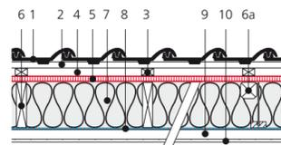
isolation entre les chevrons (nouvelle construction / rénovation)
