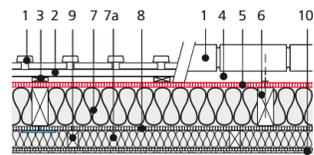
mur extérieur de la construction à ossature en bois (construction basse énergie)
