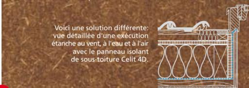
Voici une solution différente: vue détaillée d'une exécution étanche au vent, à l'eau et à l'air avec le panneau isolant de sous-toiture Celit 4D.
