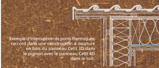
Exemple d'interruption de ponts thermiques: raccord dans une construction à ossature en bois du panneau Celit 3D dans le pignon avec le panneau Celit 4D dans le toit.
