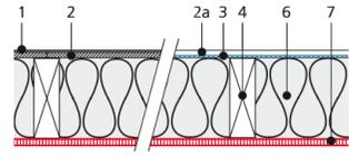
plancher à solives sur cave (plancher / plaques sous plancher)
