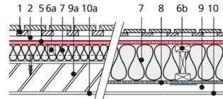
isolation sur le côté extérieur du mur massif
