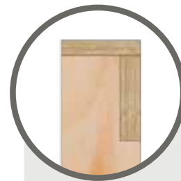
Ausgelenkter Wandständer mit durchgehendem Rähm
