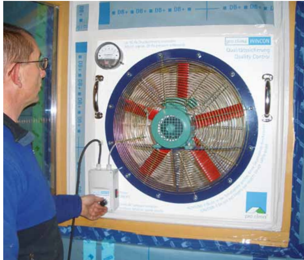
De WINCON-testventilator wordt in een raam of deur gemonteerd. Op basis van de onderdruk die in het gebouw ontstaat, kunnen lekken worden gelokaliseerd.
