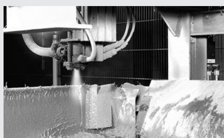
Figure 1.2 : Application de la couche sur la face côté moule
