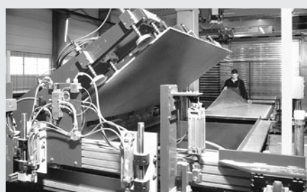
Figure 1.3 : Démoulage entièrement automatisé des plaques
