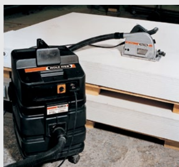
Figure 3.3 : Scie circulaire portable à aspiration de poussières
