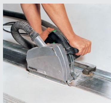
Figure 3.2 : Scie circulaire portable à rail de guidage
