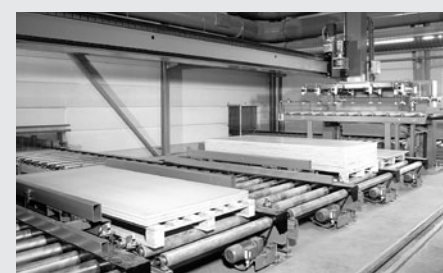
Figure 1.4 : Gerbage des plaques sur des palettes
